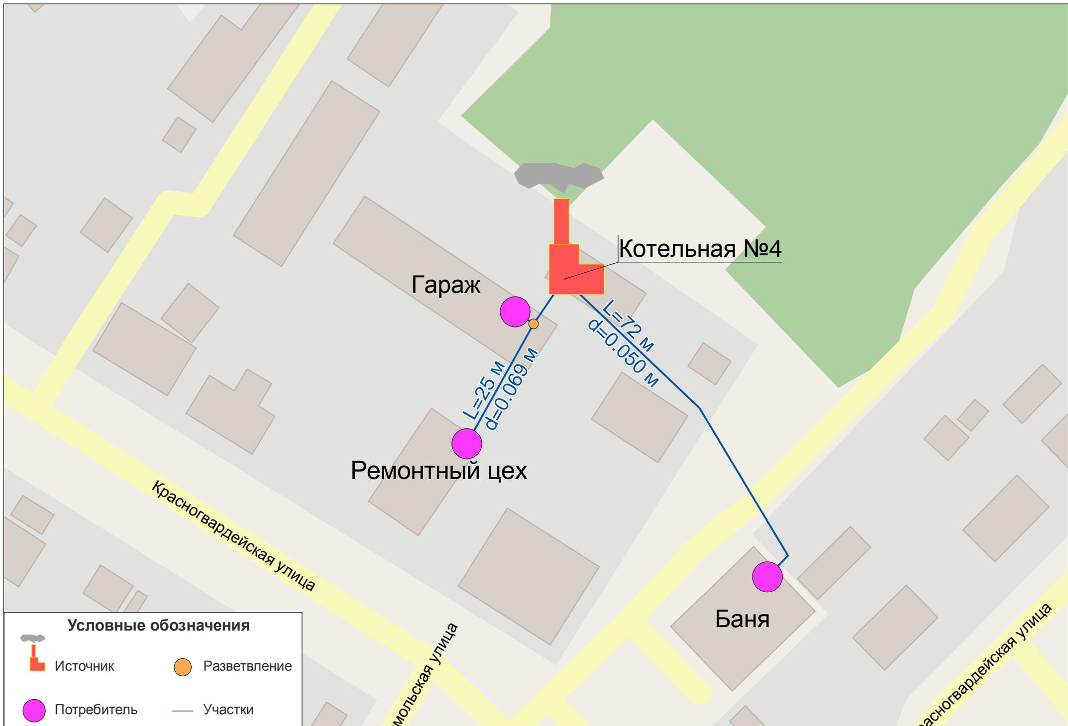
Рис. 4. Схема тепловых сетей котельной №4 "Баня"
