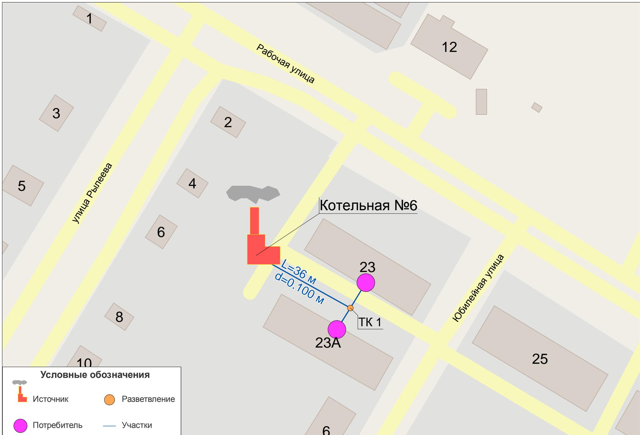
Рис. 5. Схема тепловых сетей котельной №6 "Мини"
