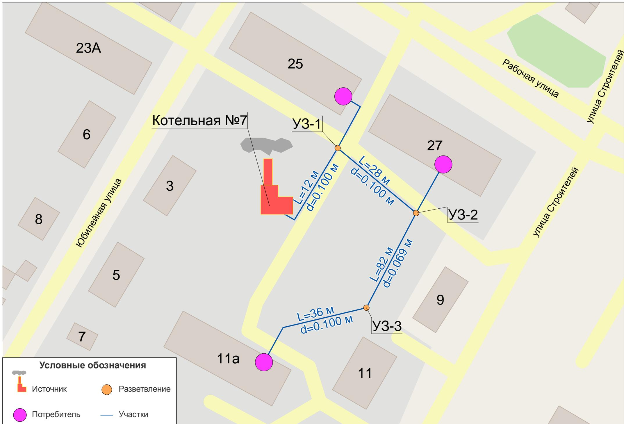
Рис. 6. Схема тепловых сетей котельной №7 "Мини"
